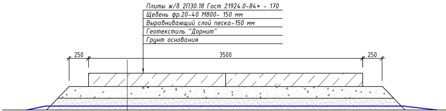
Конструкция площадки для складирования строительных материалов . М 1:25
