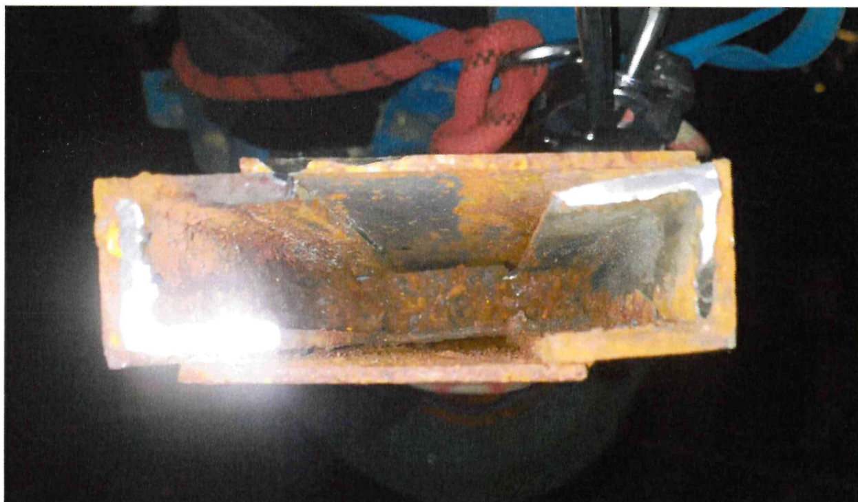
Рис.5. Сверху сечение стойки креста, снизу сечение ответной крепежной части.
